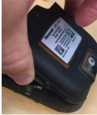
b) Skyv batteripakken på plass og stram batteriskruen (stram til 0,45–0,56 Nm).
