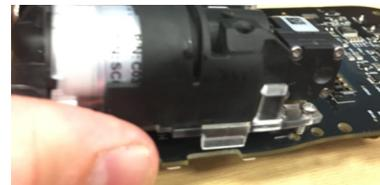
9. Sett 4R+-flatkabelen i ZIF-kontakten og trykk ned 4R+ ZIF-låsen for å feste kabelen.
