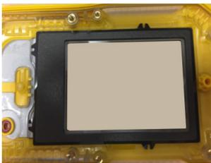
b) Skyv batteripakken på plass og stram batteriskruen (stram 0,45–0,56 Nm).
