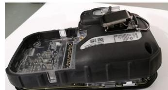
10. Sett på plass de to skruene øverst på instrumentet (stram til 0,45–0,56 Nm).
