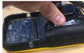
6. Sett på plass de to skruene øverst på instrumentet (stram 0,45–0,56 Nm).
