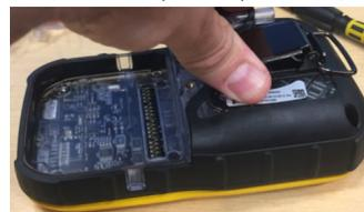
7. Sett på plass de to skruene øverst på instrumentet (stram 0,45–0,56 Nm).
