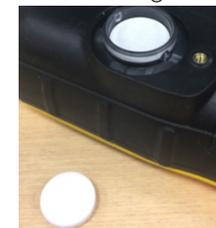
6. Monter først det hydroponiske filteret og deretter partikkelfilteret.
