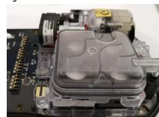
9. Sett på bakskalet og fest de fire skruene tilbake inn i batterirommet (stram til 0,45–0,56 Nm).
