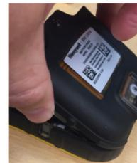
7. Skyv batteripakken på plass og stram batteriskruen (stram 0,45–0,56 Nm).
