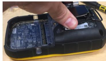
Sett på plass de to skruene øverst på instrumentet (stram 0,45–0,56 Nm).
