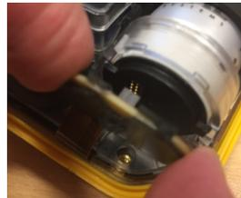
5. Sett på bakskalet og fest de fire skruene tilbake inn i batterirommet (stram 0,45–0,56 Nm).
