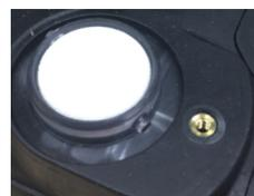
5. Fjern både partikkelfilteret og det hydroponiske filteret.
