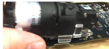
5. Løft låsen på 4R+ ZIF-kontakten og trekk ut 4R+-kabelenheten for å koble ut pumpekontakten fra kretskortet.
