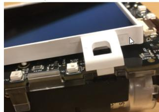
c) Pass på at LCD-pakningen er siktet inn på pinnene på frontskallet. Rammen skal være vendt opp.
