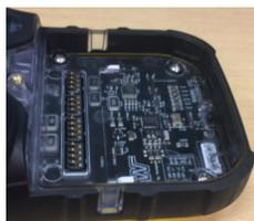
3. Fjern de to skruene øverst på instrumentet og trekk bakskalet løs fra frontskallet.
