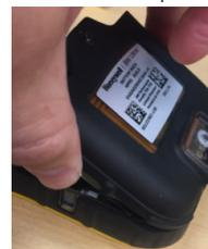
9. Skyv batteripakken på plass og stram batteriskruen (stram 0,45–0,56 Nm).
